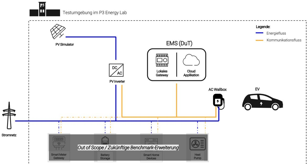
Mit Hilfe des PV-Simulators werden für den Performance Test zwei verschiedenen Szenarien über einen Zeitraum von je 5 Stunden abgefahren. Die Szenarien simulieren hierbei die PV-Erzeugnisse eines sonnigen Tages und die eines wolkenigen Tages, an dem die Solar Paneele teils verschattet sind. Die jeweiligen Kurven werden mit der von der Wallbox geladenen Energie übereinander gelegt und aus den Daten werden dann die KPIs des Autarkiegrad und Eigenverbrauch ermittelt.
